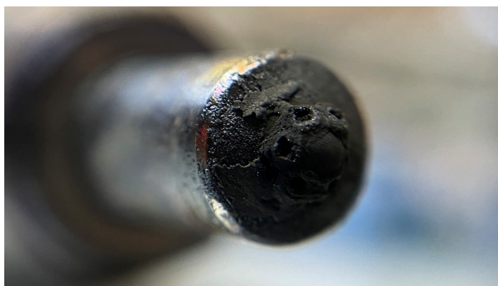
4. ábra -Az átalakított motorteknika miatt jelentős koromképződés alakul ki, ami hibás befecskendezést eredményez tovább rontva a helyzetet, a dugattyúgyűrűk megragadnak és lehántolják a hengerfalat
