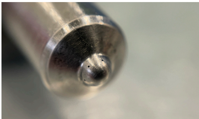
4. ábra -Az átalakított motorteknika miatt jelentős koromképződés alakul ki, ami hibás befecskendezést eredményez tovább rontva a helyzetet, a dugattyúgyűrűk megragadnak és lehántolják a hengerfalat
