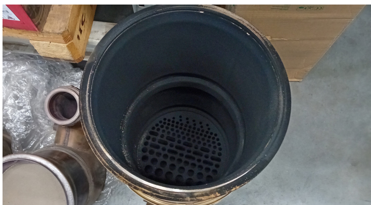
3. ábra - Kiiktatott DOC+DPF, ami miatt folyamatosan léghiányos állapotba kerül a motor, és elkezd intenzívebben kormolni
