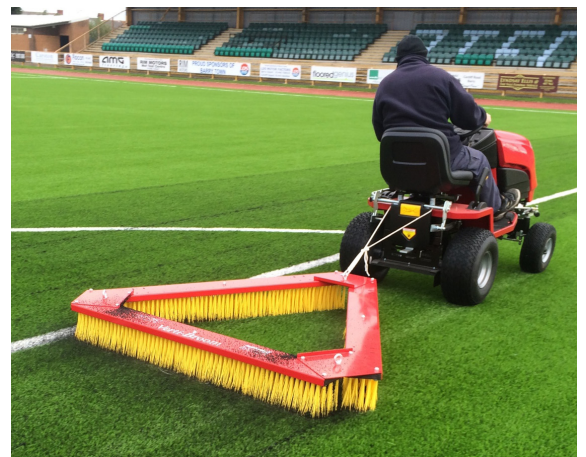
A 240-es modellt nagy, 2,4 méteres munkaszélesség jellemzi
