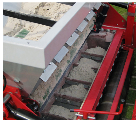
A barázda 125-200 mm mélységig kerül feltöltésre homokkal
