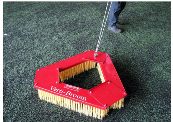
A kézzel húzható Verti-Broom WB súlya 36 kg, a munkaszélessége pedig 100 cm
