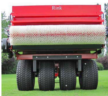
Opció: a Rink 1520 4 kisméretű önbeálló kerékkal szerelhető fel
