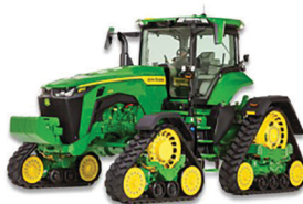
Sorközjáró hevederes járószerkezet
