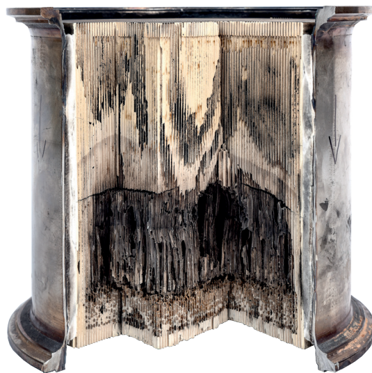
Meghibásodott dízel részecskeszűrő John Deere 6170R traktor, 4800 üzemóra
