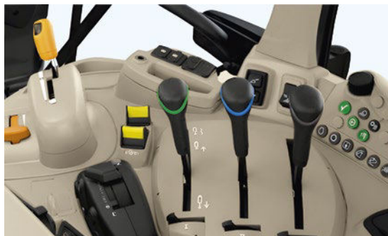
AutoPowr™ a jobb oldalon elhelyezett konzolon a mechanikus SCV-kkel
