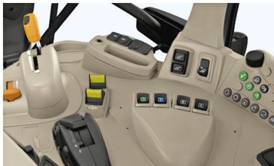
AutoPowr™ a jobb oldalon elhelyezett konzolon az elektromos SCV-kkel
