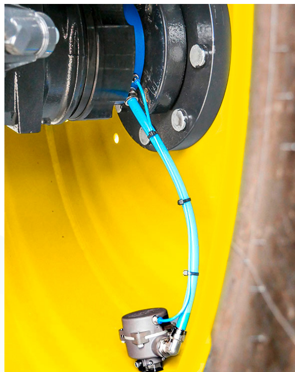
Hátsó tengelynél sárvédőn kívüli vagy tengelycsonk melletti levegőelvezetés
