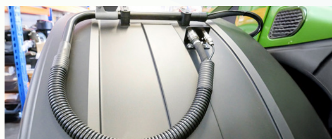
Rendkívüli körülmények között, sáros, egyenetlen, kiszámíthatatlan talajon a vezetékek parkolóállásba helyezhetők
