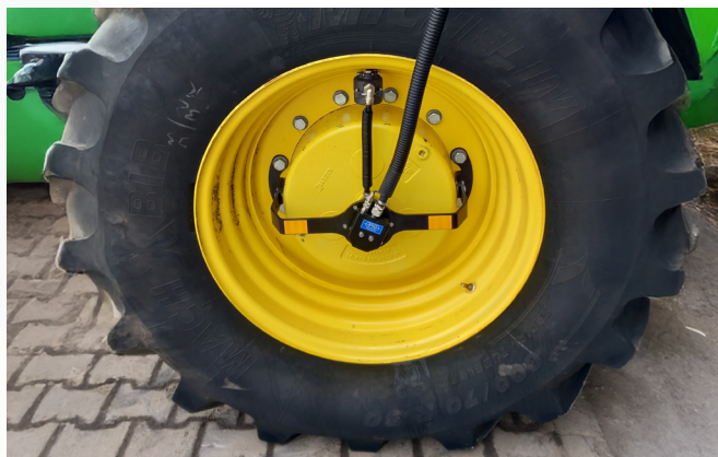
Első tengelynél sárvédőn kívüli levegőelvezetés
