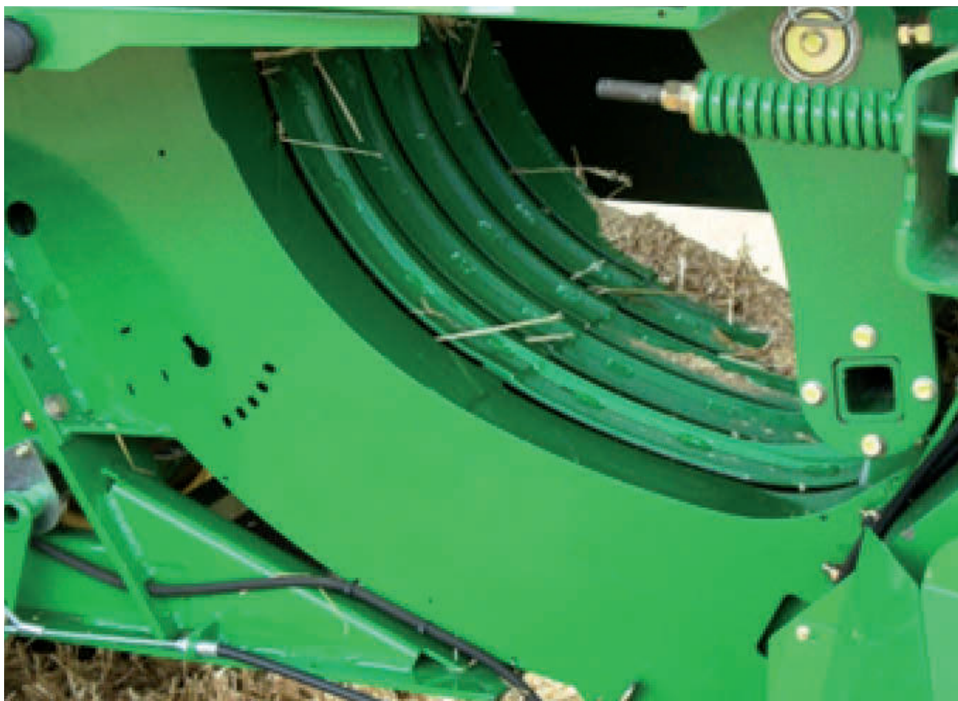
Előtömörítő csatorna és villás anyagtovábbító
