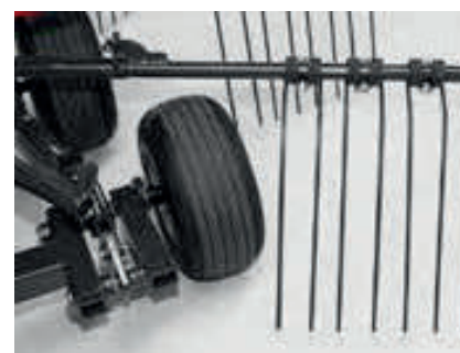
Egyenként cserélhető rugós ujjtartó karok két teflon persellyel és zsírzőszemmel.
