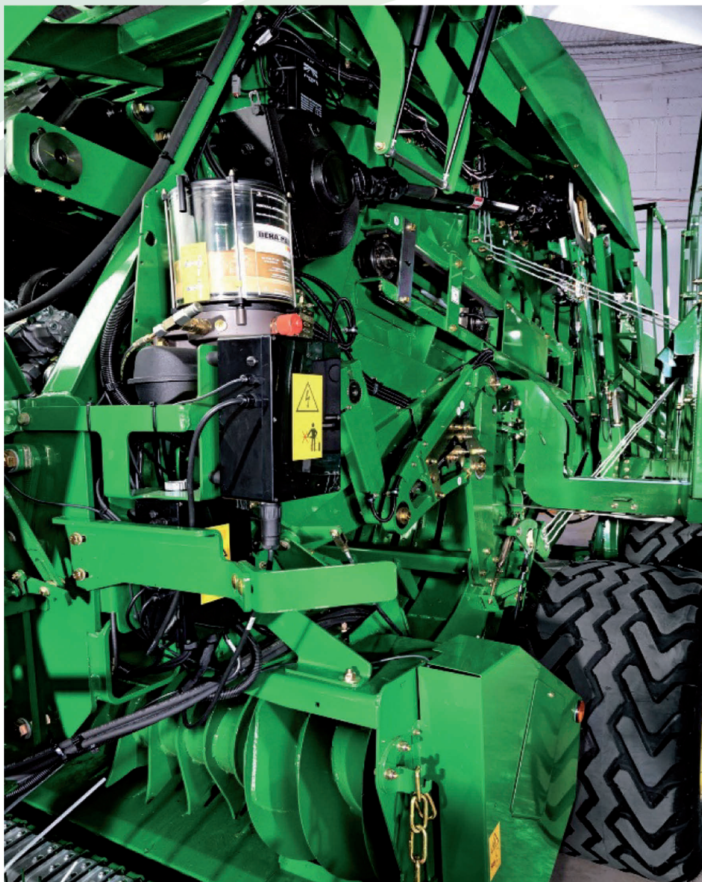
Automata kenőrendszer, integrált csigás rotor
