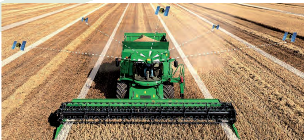
AutoTrac használatával a befejező fogás, teljes vágóasztal-szélességgel
