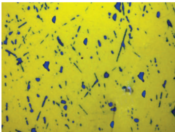
1. ábra: Heterogén cseppeloszlás, kopott fúvóka
