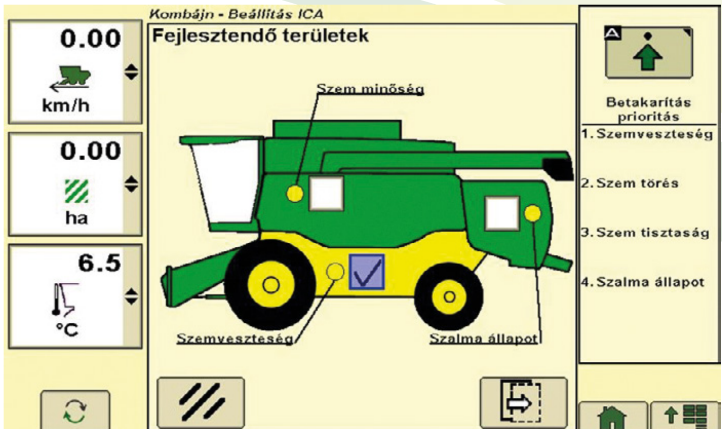
ICA interaktív kombájnbeállító rendszer: A gépkezelő számára fontos paraméterek és azok fontossági sorrendje
