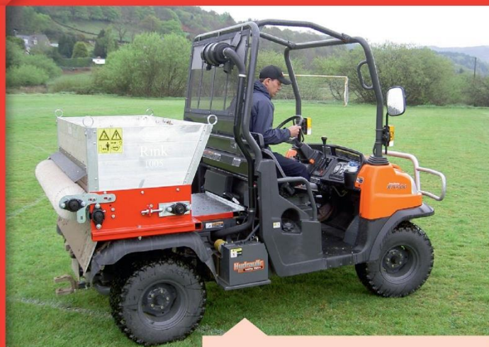
A Kubota RTV egyedi készítésű Rink 1003-mal, 0,4 m 3 -es tartály kapacitással.
