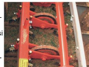
A barázda 15-22,5 cm mélységig kerül feltöltésre homokkal.
