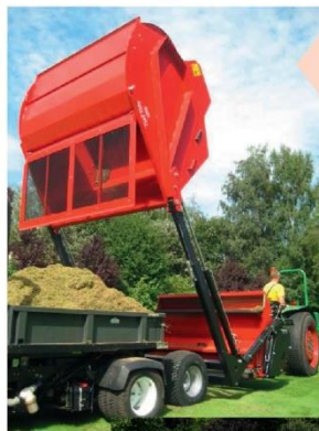
A gyűjtőtartály ürítési magassága 2,17 méter.
