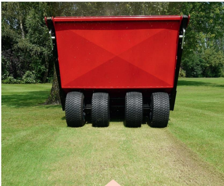
A Turf-Tidy 3000 (itt éppen gypszellőztetést végez) opcióként 4 hátsó gumikerékkel is felszerelhető.
