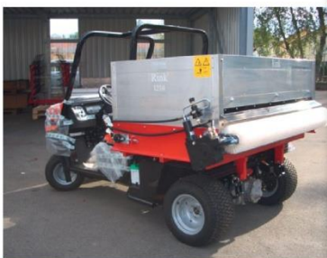
Rink 1204 a Cushman Turf Truckster-re szerelve (lásd a fenti fotót).
