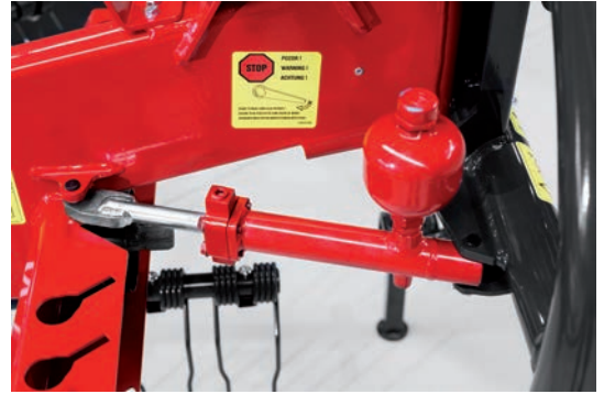
A kiegészítő lökésgátlónak (opció STAR 350|8 ALP) köszönhetően a gép könnyebben követi a traktort.
