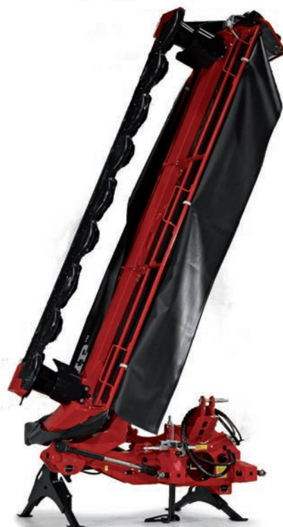
Szállítási helyzetben a kasza 120° fokban fel van billentve. Ebben a pozícióban a kasza tárolásához mindössze 3,2m2 nagyságú terület szükséges.
