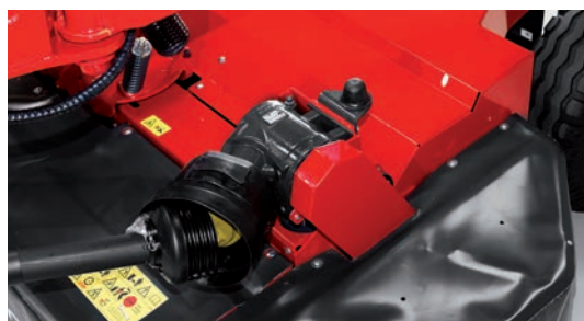
A kasza gerendén elhelyezett speciális hajtómű biztosítja a TLT kardántengely kopásának csökkentését.
