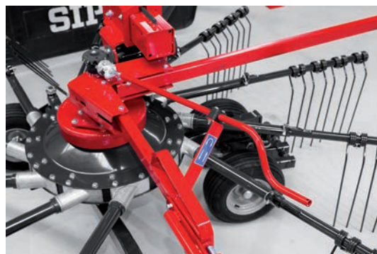
A rotor magasságának könnyű és egyszerű beállítása egy mechanikus karral.
