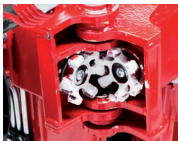
Az ujjas tengelykapcsolót sima és csendes járás jellemzi, valamint nagyobb teherviselő kapacitás.
