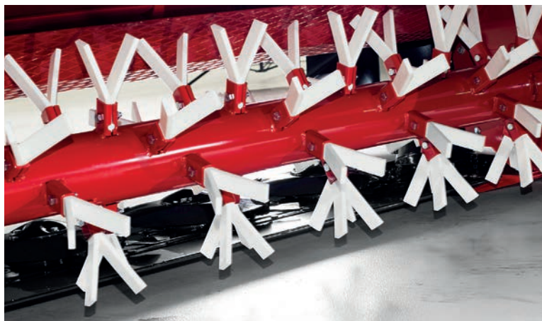
A tartós műanyagból készült, "Y" formájú ujjak csökkentik a növényi szárok károsodását és magasabb tápérték szint fenntartását biztosítják.
