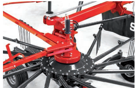
A rotor magasságának hidraulikus szabályozása.
