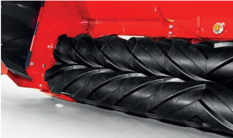
A gumihengereken kialakított bordázat megkönnyíti, olcsóbbá és gyorsabbá teszi a karbantartást.
