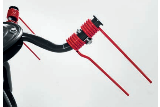
A rugós ujjpárok eltérő hosszúsága a nagy terménnytisztasághoz és védelem a törött ujjak elvesztése ellen.
