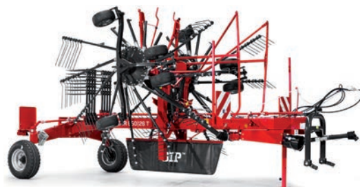
A szállítási magasság becsukott védőkeretekkel és leszerelt rugós ujjakkal kevesebb, mint 3,2 m.
