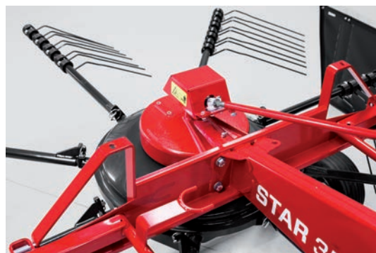
A munkamagasság a traktor fülkéből állítható.
