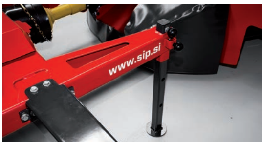
A kiegészítő kitámasztók biztosítják a tároláshoz szükséges kis helyigényt. Ebben a pozícióban a kasza tárolásához mindössze 3,2 m 2 nagyságú terület szükséges.
