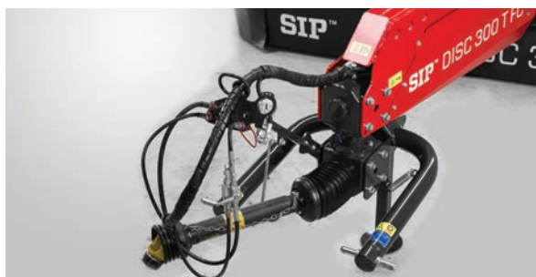
A vonórúdon elhelyezett csuklós hajtómű akár 90° fokkal is elfordítható
