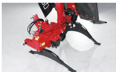
A kiegészítő kitámasztók biztosítják a tároláshoz szükséges kis helyigényt.
