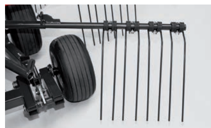
Egyenként cserélhető rugós ujjtartó karok két teflon persellyel és zsírozó szemmel.
