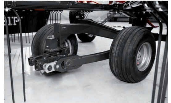
Rugalmas eltolt tandemtengely a rotoron a kiváló talajkövetéshez és a nagyobb munkasebességhez. A 4-, vagy 6-kerekes, a rugós ujjakhoz közel elhelyezett rotor alváznak köszönhető széles nyomtáv egyenletes és tiszta rendképzést biztosít a gép teljes munkaszélességében.
