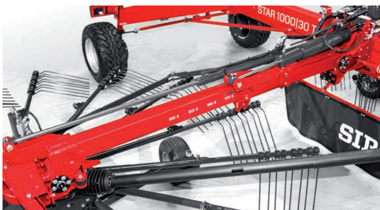
A hidraulikus és fokozatmentesen állítható rendszélesség lehetővé teszi a rendszélesség módosítását akár munkavégzés közben is.
