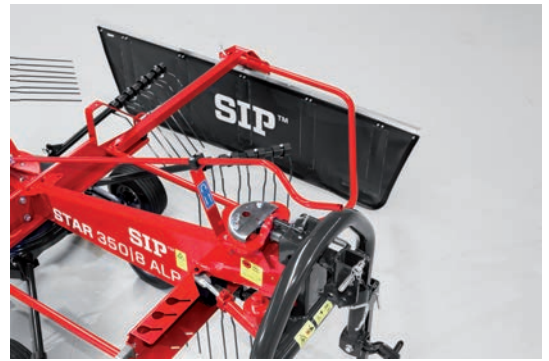
A rugós ujjak magassága (rotor magasság) könnyen állítható a traktor fülkéjéből.
