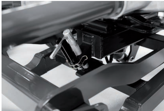
A rotor magasságának könnyű és egyszerű beállítása egy csavarral.
