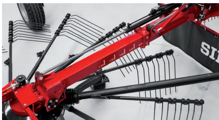
A hidraulikusan és fokozatmentesen állítható rendszélesség lehetővé teszi a rendszélesség módosítását akár munkavégzés közben is (STAR 850I26 T).
