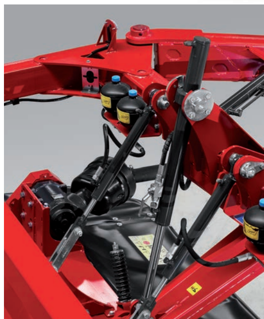
A kasza hidraulika rendszere dupla burkolattal ellátott hidraulika tömlőket tartalmaz, amelyek akár 280 bar nyomást is képesek elviselni, valamint zárt körös munkahengereket, amelyek megnövelik a hidraulika rendszer élettartamát.
