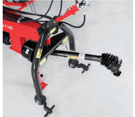
A vontatott változat kapcsolóváza nagy hajtásszögű kardántengellyel lehetővé teszi, hogy a gép tökéletesen kövesse a traktort, és kisebb fordulási sugarat biztosít.
