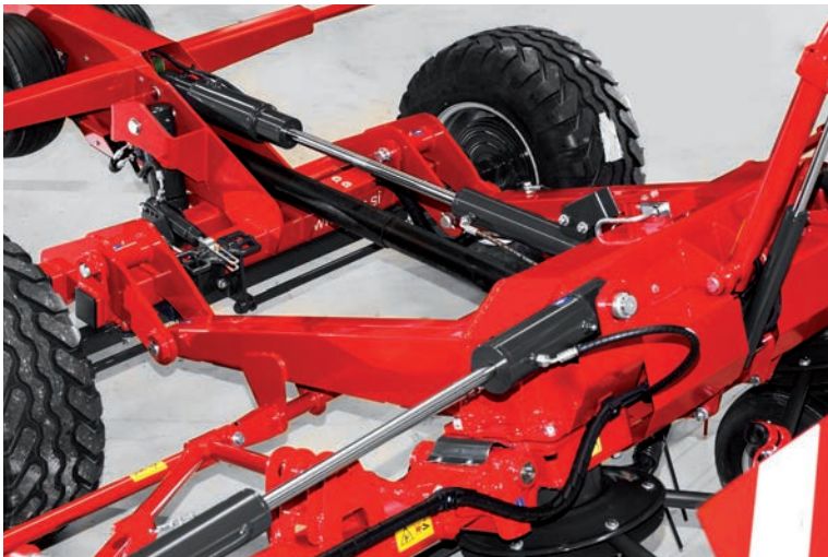
Rotor dőlésszög szabályozás (SIP szabadalom) 15° és 21° fok között (opcióként hidraulikus beállítás) a termény egyenletes szétterítéséhez.
