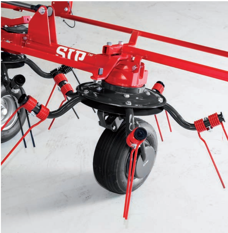
A rotor és a rugós ujjtartó karok nagy terhelésnek vannak kitéve fordulásakor, ezért a karok csőből készülnek, rendkívüli torziós szilárdságú anyagból. A rotor alaplemezhez csavarkötéssel rögzülnek, valamint hornyokkal ellátott erősítő gyűrű biztosítja a stabilitásukat.
