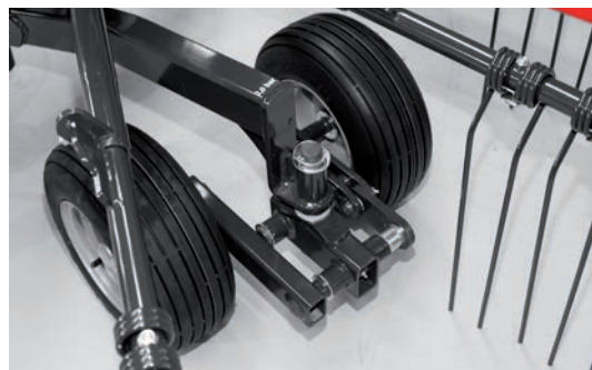
Rugalmas eltolt tandemtengely a rotoron a kiváló talajkөvetéshez és a nagyobb munkasebességhez. A 4-, vagy 6-kerekes, a rugós ujjakhoz közel elhelyezett rotor alváznak köszönhető széles nyomtáv egyenletes és tiszta rendképzést biztosít a gép teljes munkaszélességében.
