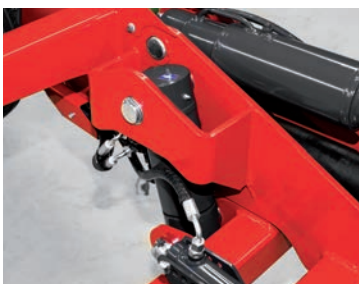
Rotor dőlésszög szabályozás (SIP szabadalom) – hidraulikus állítás (opció).
