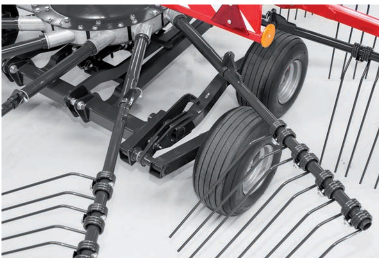
Az eltolt tandemtengely (SIP szabadalom) az alapfelszereltség része. Kiváló talajkövetést, nagyobb munkasebességet, és akár 40 km/h szállítási sebességet tesz lehetővé.
