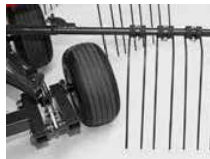
Egyenként cserélhető rugós ujjtartó karok két teflon persellyel és zsírzószemmel.
