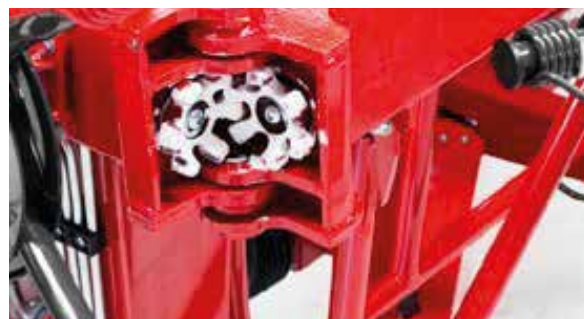
Az ujjas tengelykapcsoló semmiféle karbantartást nem igényel, és minden körülmények között megbízható erőátvitelt tesz lehetővé.
