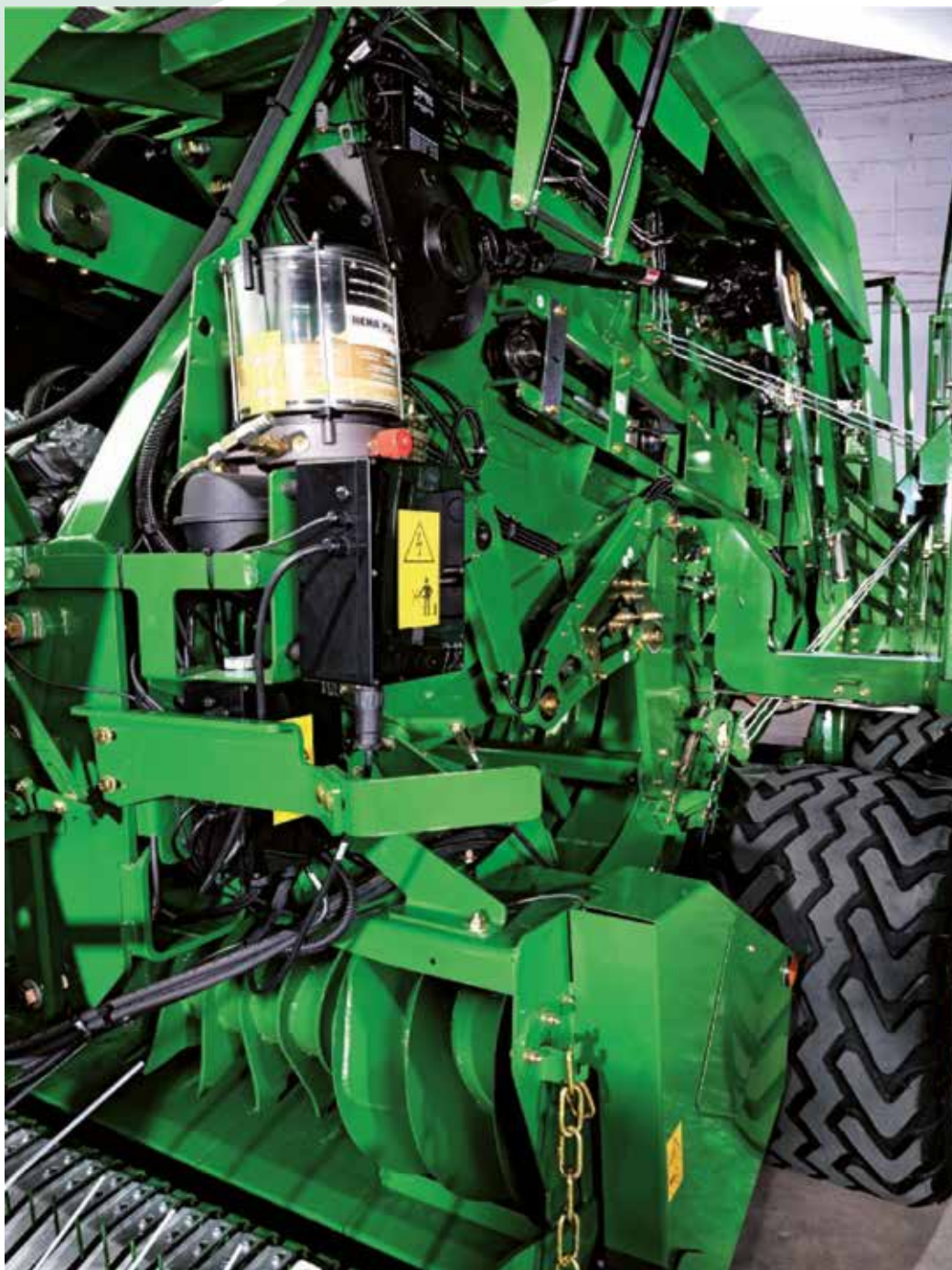
Automata kenőrendszer, integrált csigás rotor
