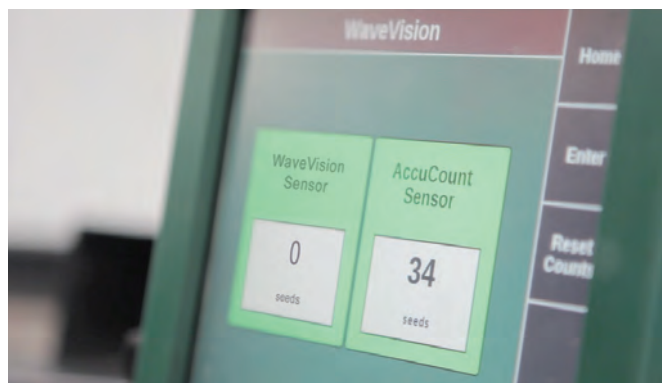
A WaveVision® szenzort nem zavarja össze a por, mint az optikai szenzort. Nézze meg a különbséget, hogy a két szenzor mit jelzett a 20|20 SeedSense® részére.
