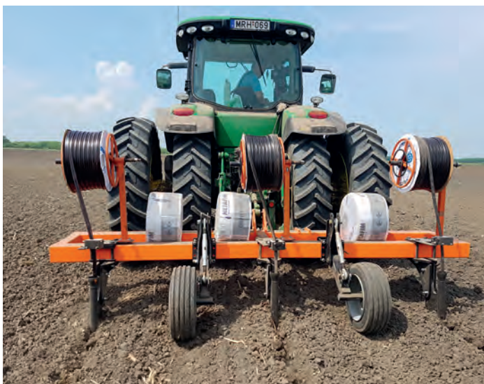
Csepegtetőcsövek telepítése GPS technológiával 30-35 cm mélyen
